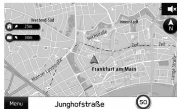
Le signal GPS peut être physiquement bloqué, entraînant une position imprécise du véhicule sur l'écran de carte. Les signaux GPS peuvent être bloqués par des tunnels, de grands immeubles, des camions ou même par des objets placés sur le tableau de bord.
