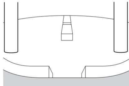
La zone située au-dessus de la caméra ne peut pas être visualisée. En présence d'un objet dont la partie supérieure présente une saillie importante, par exemple un panneau de signalisation situé derrière le véhicule, la saillie ne peut pas être visualisée sur l'écran.
