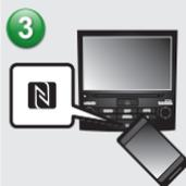
Activez la fonction Bluetooth du téléphone/dispositif Bluetooth et sélectionnez « Subaru BT ». Si vous enregistrez un appareil compatible NFC\*, maintenez-le contre le logo NFC du système audio/visuel jusqu'à ce qu'une connexion soit établie.
