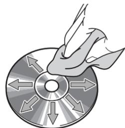
**Pour nettoyer un disque:** Essuyez-le avec un chiffon doux, non pelucheux qui a été humidifié avec de l'eau. Essuyez en ligne droite en partant du centre vers le bord du disque (non en cercles). Séchez-le avec un autre chiffon doux, non pelucheux. N'utilisez pas de nettoyant pour disque classique ou de dispositif antistatique.
