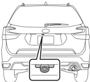
Lorsque le contacteur d'allumage est placé sur « ON » et que le levier de sélection est placé sur « R », la caméra de vue arrière affiche automatiquement l'image de la vue arrière de l'arrière du véhicule. L'image de la caméra de vue arrière s'affiche sur ce système.
